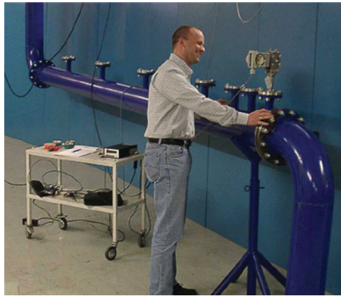
Am systec-Prüfstand wird der Einfluss verkürzter Einlaufstrecken auf die deltaflow ermittelt.
